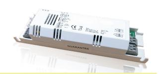
Technische Daten: Versorgungsspannung: 230 V AC 50 Hz Ausgangsleistung: 1-9 W (100 mA -750 mA) Max. LED Leistung Batteriebetrieb: 9 W Max. Leistung Dauerbetreib: 80 W Temperaturbereich: 0 - 50 °C Batterietyp: LiFePO<sub>4</sub> Batteriespannung: 9,6 V (3 - 6 Ah) Max. Ladezeit: 24h Versorgungszeit: 1h, 3h, 8h Schutzart: IP 20 Anschlussklemmen: 0,5 - 1,5 mm<sup>2</sup>
