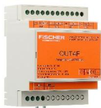
Das OUT4F Modul ist ein universelles Ausgangsgerät für den Betrieb zwischen elektrischen Geräten, der Gebäudeleittechnik und dem Zentralbatteriesystem INSiLIA2. Es wird direkt im Endstromkreis angeschlossen. Das Modul OUT4F verfügt über 4 Relaisausgänge zur Steuerung oder Signalisierung beliebiger Geräte. Die Datenübertragung zwischen dem Modul und dem INSiLIA2 System erfolgt über das gleiche Kabel, das auch die Stromversorgung gewährleistet.
