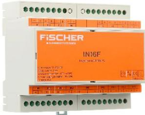
Das Modul IN16F ist ein mit Eingängen für die Kommunikation zwischen den Geräten der Gebäudeinstallation und dem Zentralbatteriesystem INSiLIA2 ausgestattet. Es wird direkt im Endstromkreis angeschlossen. Das Modul IN16F hat 16 potentialfreie Eingänge mit der Möglichkeit, die Auslöselogik zu ändern. Die Datenübertragung zwischen dem Modul und dem INSiLIA2 System erfolgt über das gleiche Kabel, das auch die Stromversorgung gewährleistet.
