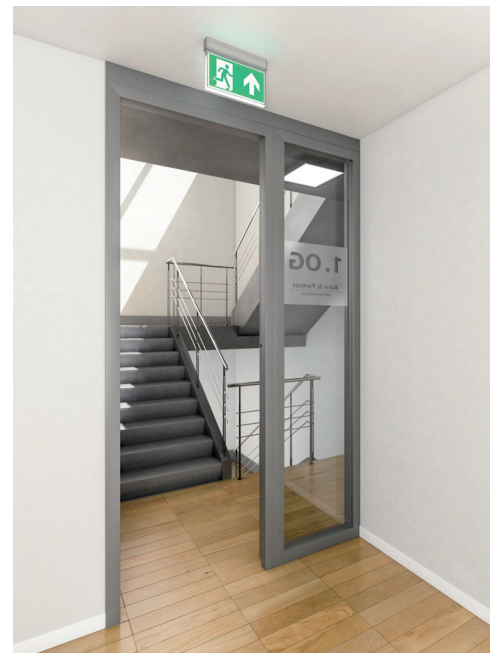
Abb. 3: Anzeige der Fluchtrichtung „Pfeil nach oben“ ins Treppenhaus im 1. OG
